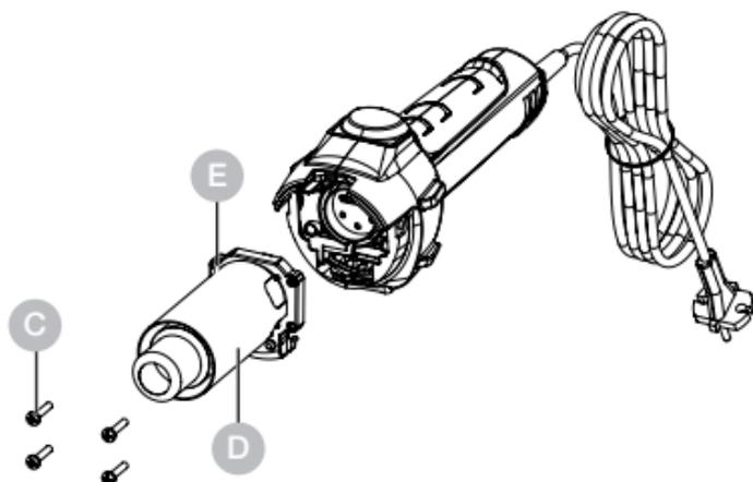
4. 拧下通风管末端的四个螺丝 (C)。
