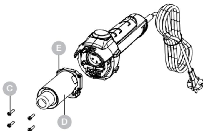
4. Svitare le 4 viti alla fine del tubo di soffiaggio **C**.
