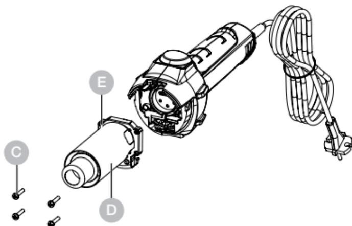
4. Die 4 Schrauben am Ende des Ausblasrohres lösen (C).
