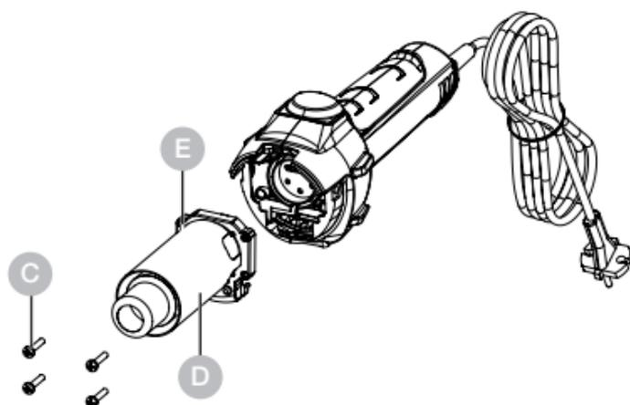
4. Выкрутите 4 винта, расположенных на конце выходного сопла **C**.
